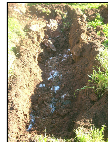
Foto 3.- Detalle calicata C-4. Afloramiento calizas por debajo de suelo vegetal.
